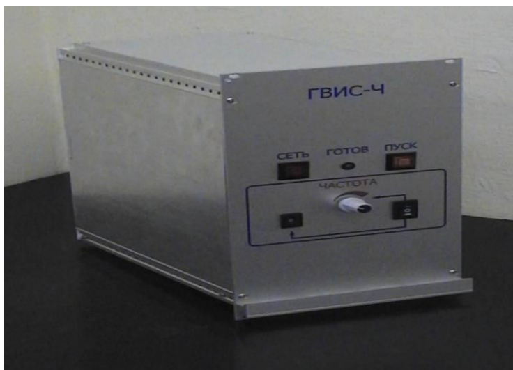
Рисунок 6. Генератор наносекундных высоковольтных электрических импульсов для активации и модификации биообъектов
