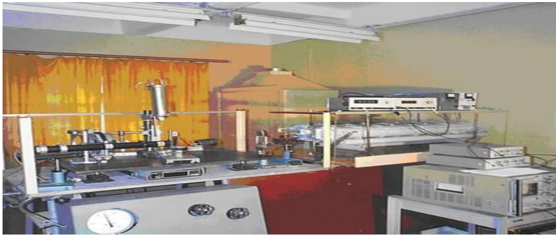
Рисунок 1 Установка на основе CO 2 -лазера для осуществления фотохимической модификации биоматериалов.
