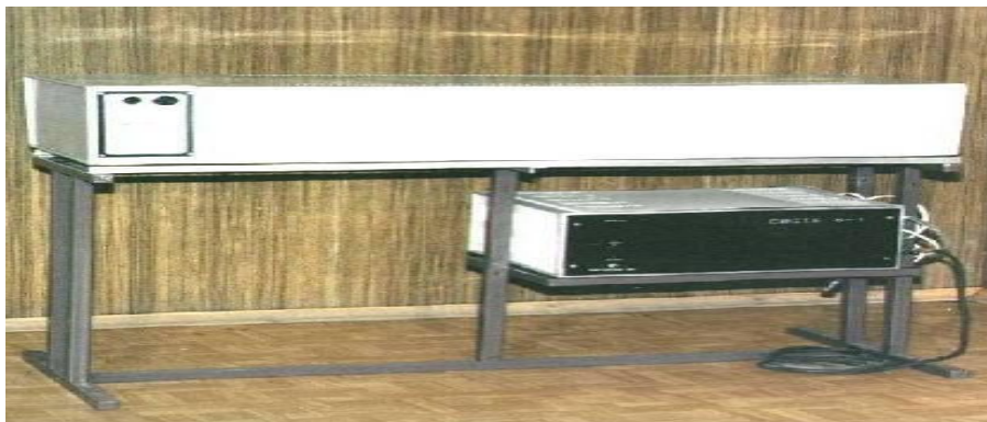
Рисунок 2 Лазер с активными средами на парах меди для активации клеток-эффекторов иммунной системы кожи.
