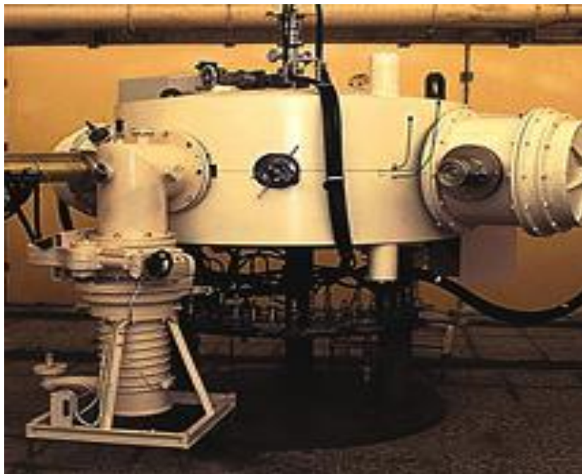
Рисунок 5. Широкоапертурный ускоритель электронов для модификации биоматериалов
