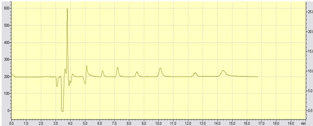
Рисунок 2.1 – Хроматограмма смеси внешних стандартов в концентрации 5нг/мл. Порядок выхода стандартов после пика ввода, заканчивающегося на 5-ой минуте: норадреналин, дофамин, 3,4-диоксифенилуксусная кислота, 5-оксииндолилуксусная кислота, серотонин, гомованилиновая кислота.
